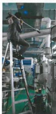
喷砂车间15号机废气处理前取样口
