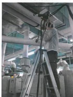
喷砂车间9号机废气处理前取样口
