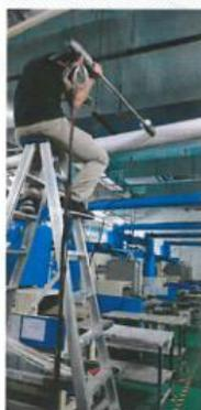
喷砂车间13号机废气处理前取样口
